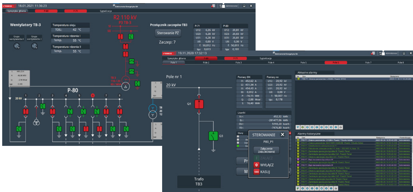
Schemat synoptyczny systemu e 2 YANKEE dla pól rozdzielczych w stacji GPZ
