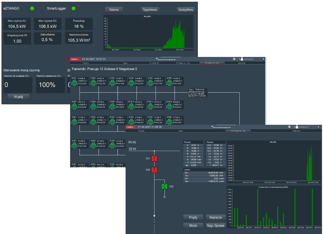
Schemat synoptyczny systemu e 2 YANKEE dla farmy fotowoltaicznej i stacji GPO
