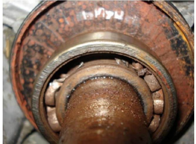
Rys. 3. Widok uszkodzonego łożyska w silniku, uszkodzone bieżnie, pęknięty koszyk i brak części kulek [4].
