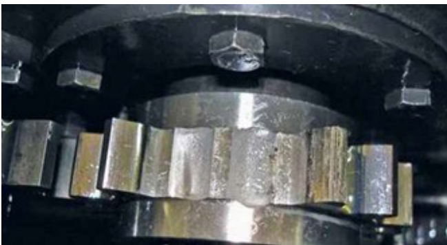
Rys. 4. Widok uszkodzonej przekładni zębatej sprzęgu w postaci wyłamania dwóch zębów i uszkodzenia powierzchni trzeciego [5].
