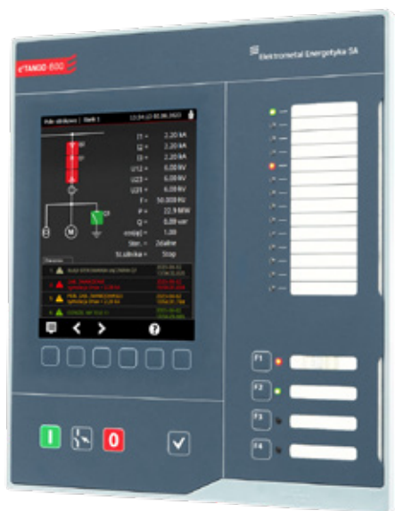
Rys.5. Widok sterownika polowego e 2 TANGO-800 zabezpieczającego pole silnikowe.
