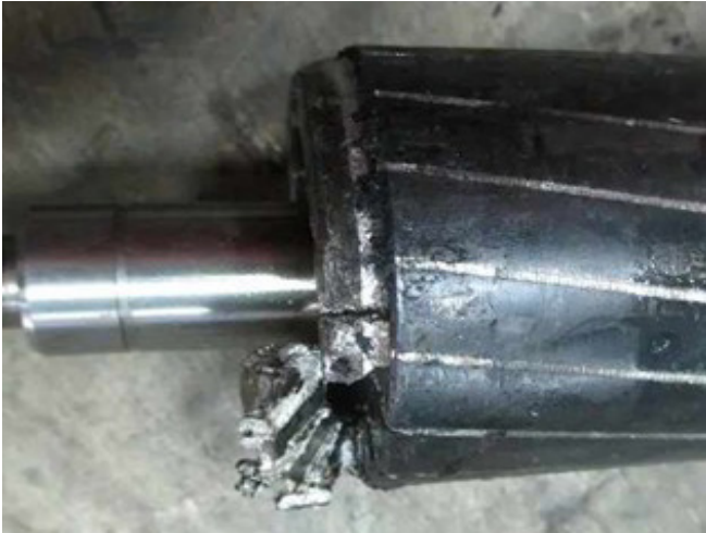
Rys. 2. Widok uszkodzonego wirnika, rozerwane połączenia czołowe prętów i pierścienia [3].
